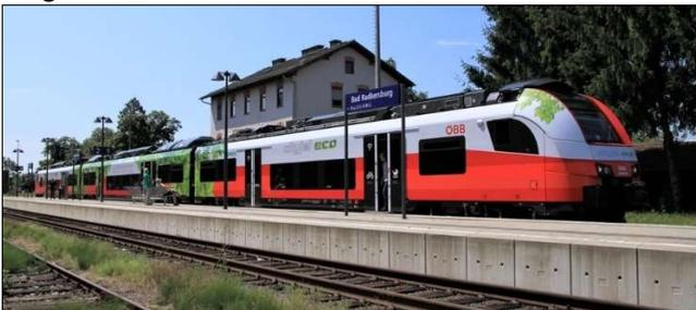
Der Cityjet eco bietet Platz für 244 Fahrgäste und ist 75 Meter lang. Der Triebwagen ist vollklimatisiert und kann auch im Batteriemodus immerhin 120 km/h schnell fahren und das 80 Kilometer weit, ehe er wieder aufgeladen werden muss. Sie können sich von den Vorteilen dieses superleisen und abgasfreien Fahrzeuges von **18. November bis zum 13. Dezember** selbst überzeugen. In dieser Zeit sind Probefahrten für folgende Züge geplant:
